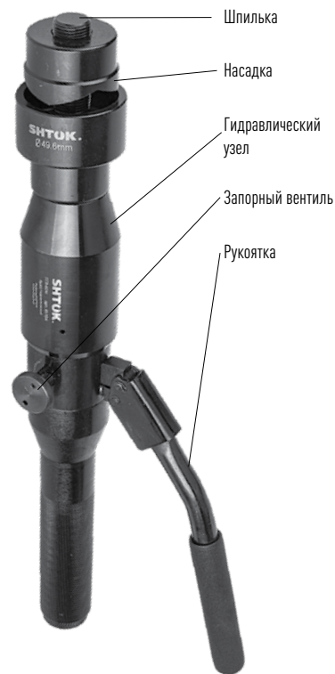
Рисунок 1 – Устройство перфоратора гидравлического листового.
