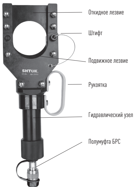
Рисунок 1 – Устройство насадки для резки кабеля.
